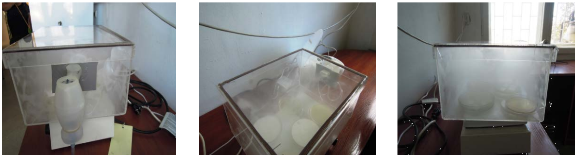
სურ 19. ექსპერიმენტული კამერა, რომელთანაც მიერთებულია ნებულაიზერი ფაგის მიკროაეროზოლის შესაქმნელად. (მარჯვნიდან მარცხნივ: 1- მიკროაეროზოლის დიფუზია კამერაში, 2-3 - ფაგის მიკროაეროზოლით სავსე კამერა).
